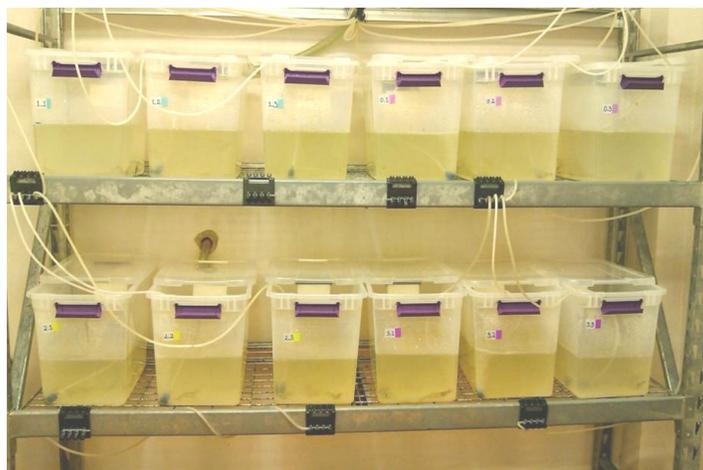
Fig. 7.3. Montaje de bioensayo de confirmación exponiendo a *L. vannamei* a diferentes concentraciones de NH<sub>4</sub><sup>+</sup> y NO<sub>2</sub><sup>-</sup> a una salinidad de 1.9 g/L.
