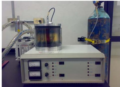
**Figura 13.** Evaporadora marca EMB 550 sputter coater
