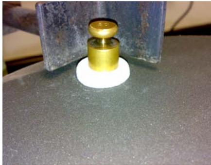
**Figura 15.** Probeta de biomaterial colocada sobre el equipo de abrasión.
