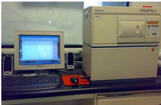
**Figura 8.** Difractómetro de Rayos X para método de polvos, marca Rigaku modelo Miniflex.
