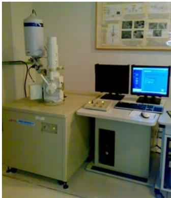
**Figura 11.** Microscopio Electrónico de Barrido marca Jeol modelo JSM 6060LV
