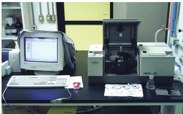
**Figura 10.** Espectrómetro de Infra Rojo marca Bruker modelo Alpha-T
