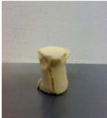
**Figura 29** Probeta de biomaterial después del ensayo de compresión
