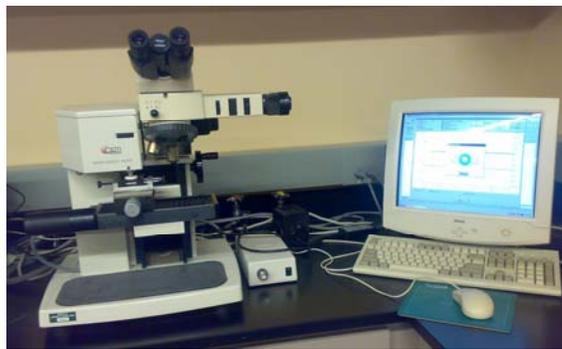
**Figura 19.** Equipo Micro Probador de rayaduras (MST) de Instruments CSEM, Neuchatel Switzerland.
