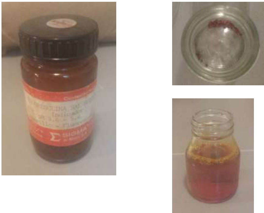
Figura 1: Fluoresceína en su presentación como reactivo de laboratorio (izquierda), su aspecto a simple vista (superior) y la solución preparada (inferior).
