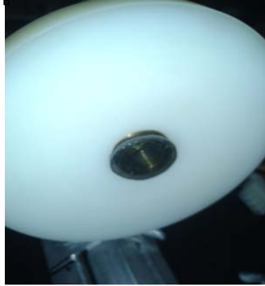
Fig. 4.2 Polarizador montado en tornillo de teflón.
