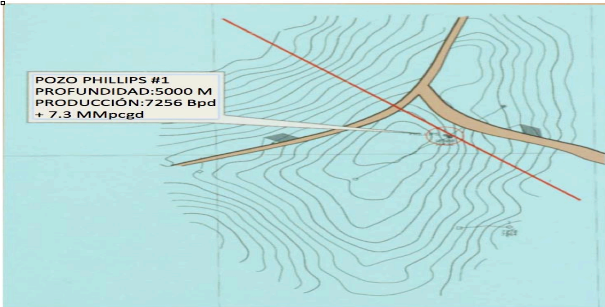
Figura 3.14 Campo Mahogany. Fue descubierto por el pozo Phillips Núm. 1, ubicado a 130 km de la costa de Louisiana. Consta de un anticlinal afallado cubierto por un canopy de sal alóctona (Modificada de Harrison et al., 2010).
