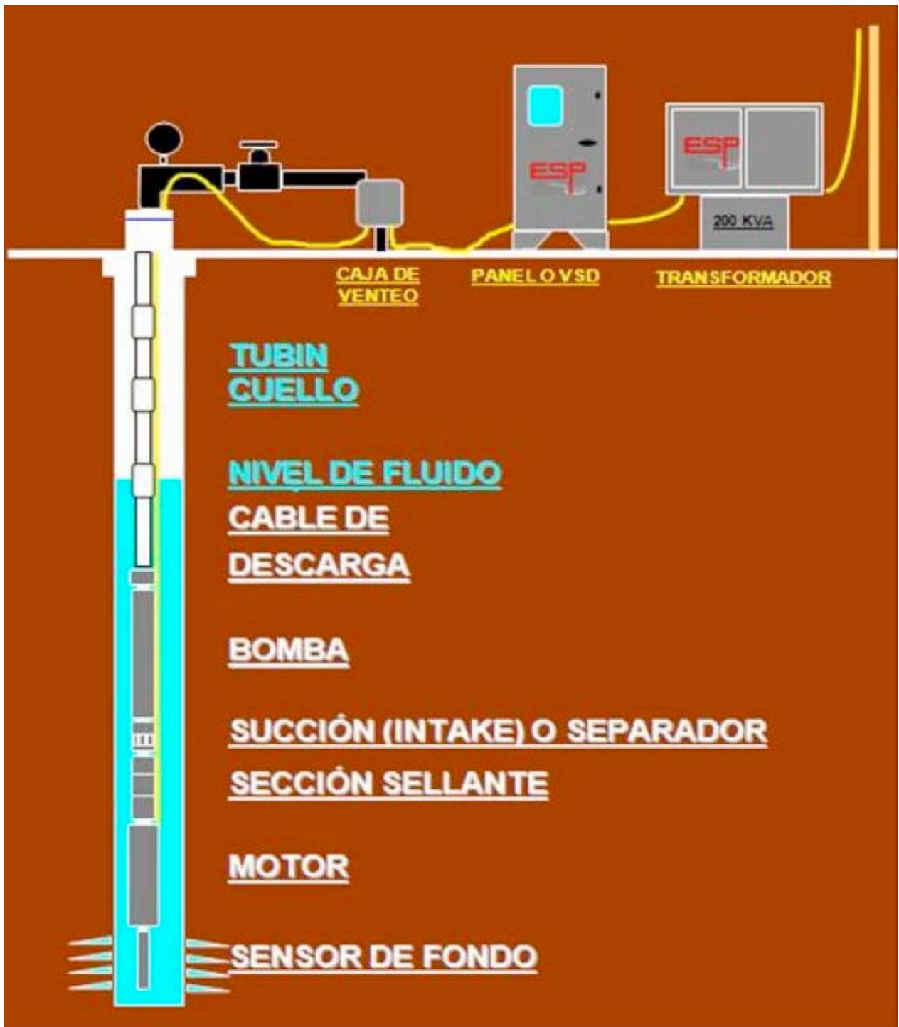
Figura 5.3 El esquema muestra los principales componentes de un sistema de bombeo electrocentrífugo (Tomada de Téllez González, 2014).
