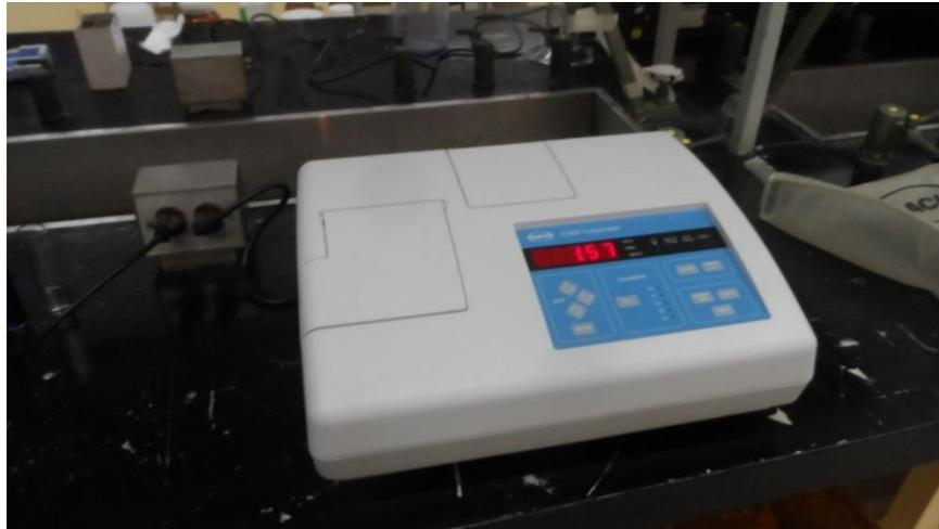
Imagen 28. Turbidímetro o Nefelómetro
