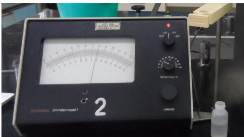
Imagen 26. Medidor de pH
