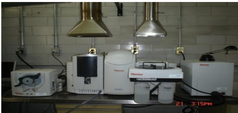
Figura IV. EAA Marca Thermo adaptado con el generador de hidruros
