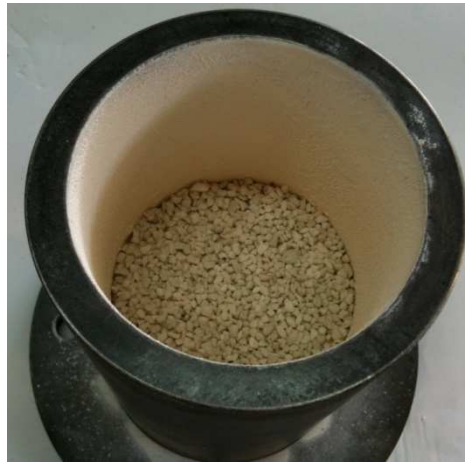
Figura 2.2. 2 Preforma colocada en el crisol de infiltración, ya preparado con recubrimiento de nitruro de boro.
