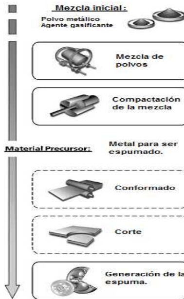
Figura 1.3. 3 Diagrama del proceso de fabricación por polvos [2].
