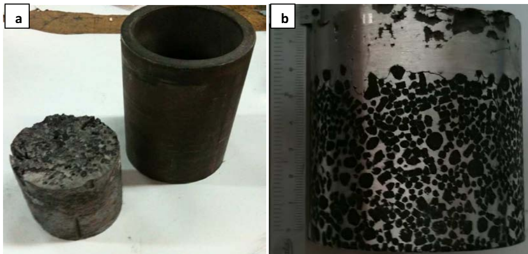
Figura 2.4. 1 Ejemplo de espuma recién obtenida del proceso (a) y maquinada para revisión (b)
