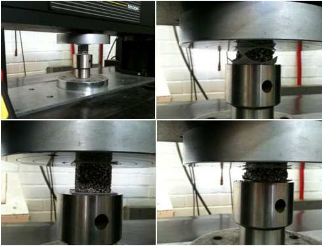
Figura 2.4. 3 Configuración del dispositivo, en distintas etapas del ensayo a compresión.
