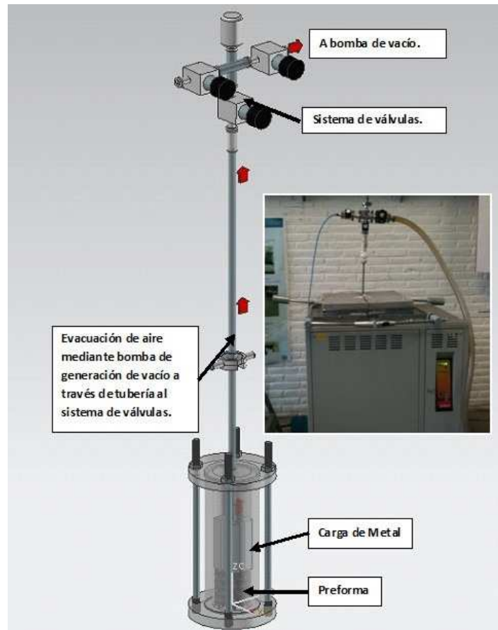
Figura 2.3. 1 Esquema representativo de la etapa de generación de vacío, en la imagen se presenta esta etapa en el equipo utilizado.
