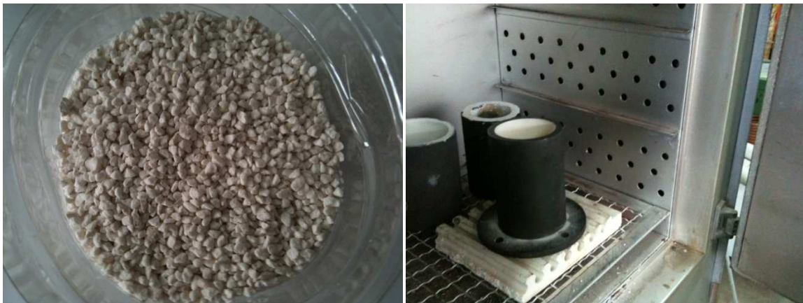
Figura 2.2. 4 Preforma pre-ensamblada y crisol preparado para tratamiento de eliminación de humedad.
