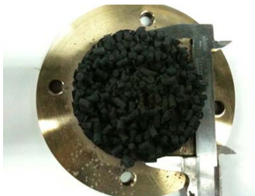
Figura 2.2. 6 Características de la preforma, ya sometida al tratamiento de calcinación.
