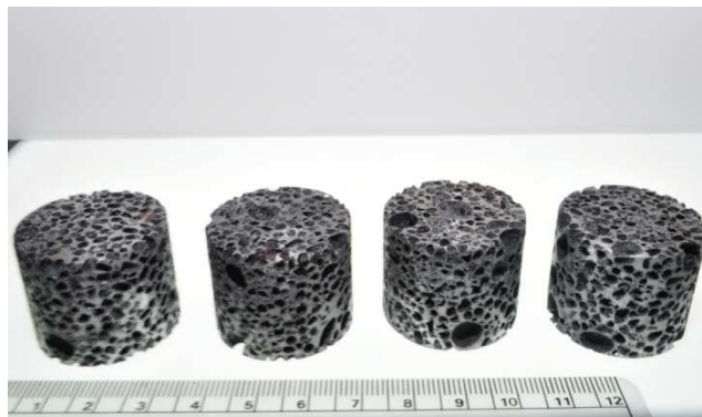
Figura 2.4. 2 Ejemplo de probetas obtenidas por maquinado, ya con preparación para ensayo de compresión.
