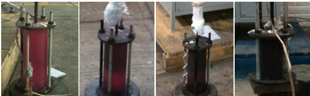
Figura 2.3. 5 Crisol durante distintas etapas del enfriamiento, implementación de placa de cobre para enfriamiento acelerado desde la parte inferior del crisol.
