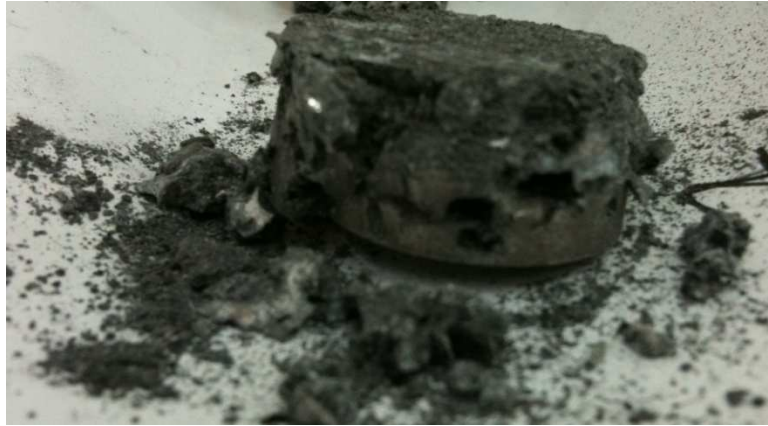
Figura 3.2. 5 Probeta fracturada con gran cantidad de residuos de preforma.
