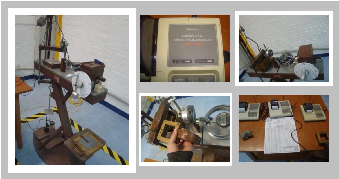
Colocación de caja de corte y las impresoras de datos que registran los datos arrojados de los micrómetros digitales en el Equipo de Corte Directo
