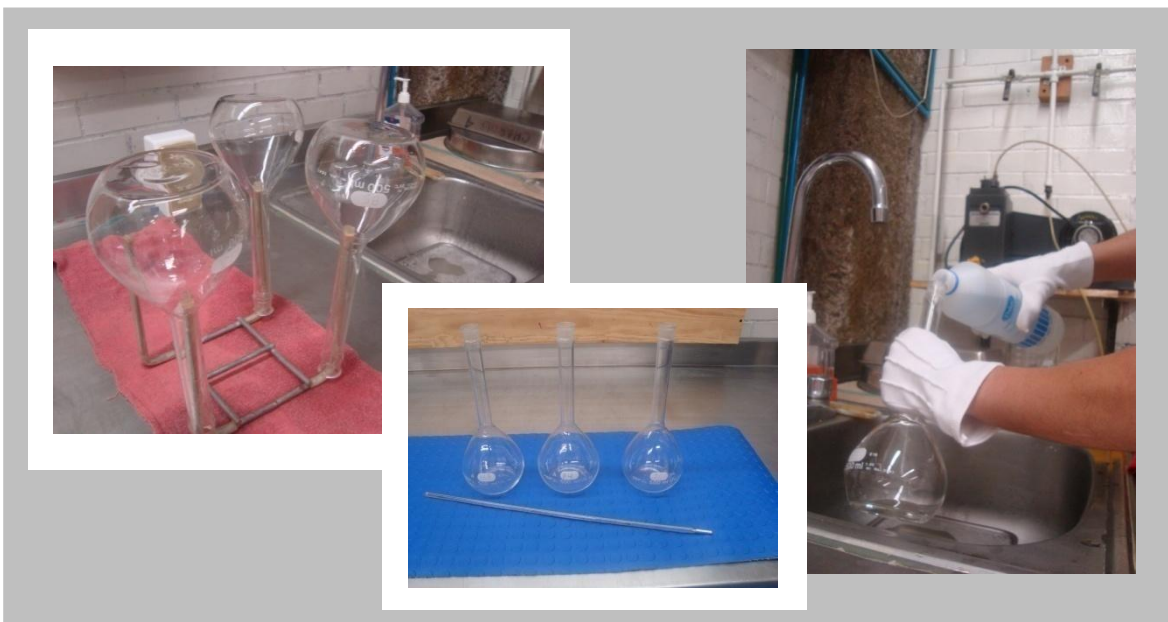
Secado de matraces aforados y posteriormente limpieza con alcohol
