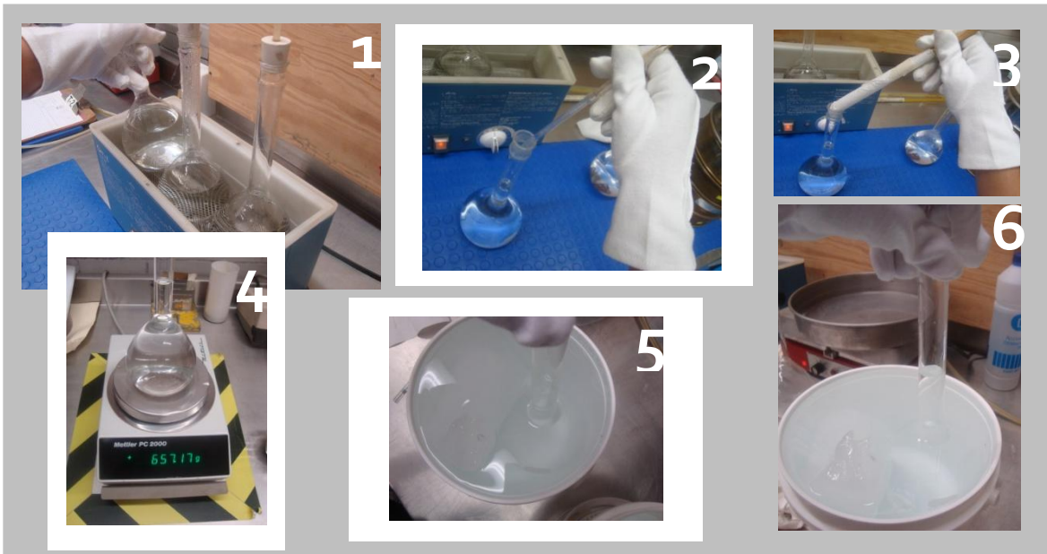
Calibración de los matraces 1) desaireado 2) aforar con pipeta 3) secado de las paredes 4) Peso a esa temperatura 5) y 6) Uso de hielo para bajar la temperatura y obtener la curva de calibración
