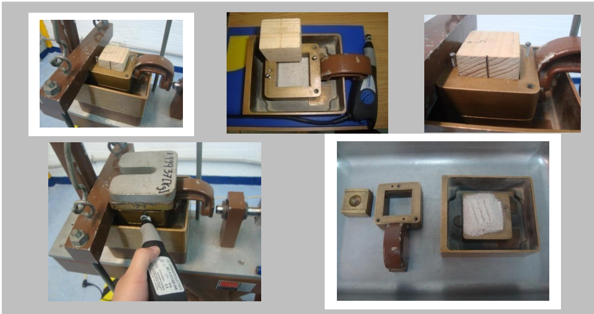
Colocación de cubo de madera para confinamiento de las partículas al vibrar, colocación de peso muerto y por último limpiar Caja de Corte para realizar el siguiente ensayo
