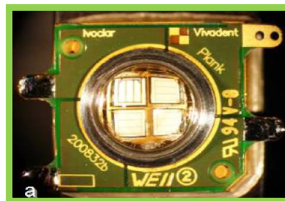
Figura no. 17 Se observan los semiconductores de una lámpara LED de segunda generación los cuales al aplicarles un voltaje los electrones se conectan y producen luz en el rango de espectro de 440- 490nm. Tomada de Norberto Calvo, Unidades y protocolos de fotocurado, Academia Colombiana de Operatoria Dental Estética y Biomateriales / Boletín científico 2010; (2)
