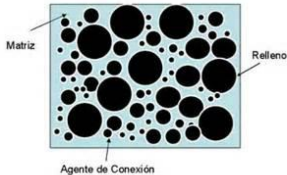
Figura no. 1 Se observa la composición de la resina compuesta, Tomado de Rodríguez D, Pereira N. Evolución y tendencias actuales en Resinas Compuestas. Acta Odontológica Venezolana 2008; vol.46.
