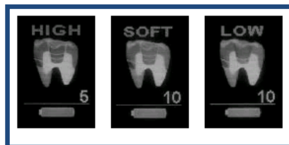
Figura no. 32 se ilustran los programas y tiempos de polimerización. Tomada de http://www.ivoclarvivadent.com.mx/es-mx/bluephase-1-1
