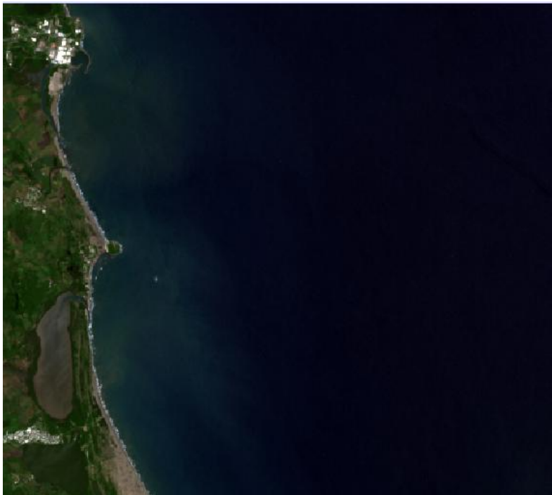
Figura 4.19. Imagen de la CNLV en color verdadero (Combinación RGB: B04, B03, B02).
