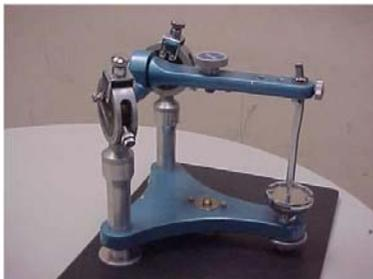
Fig. 12 1944, Dentatus, totalmente ajustable.<sup>7</sup>
