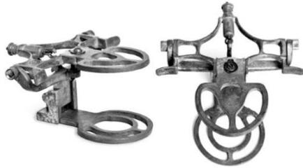
Fig. 4 Articulador de Antes-Lewis. Éste articulador podía reproducir el movimiento de protrusión.<sup>5</sup>
