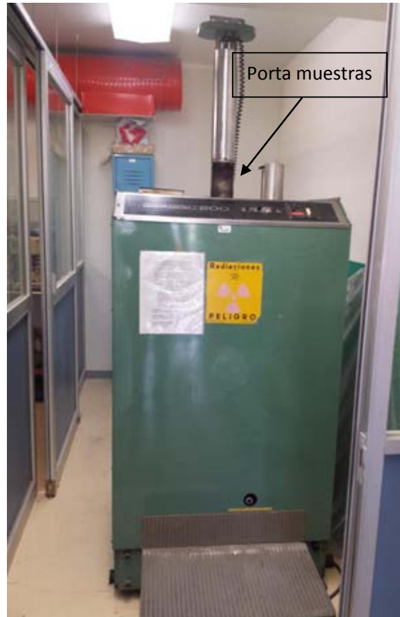
Figura 2.1 Irradiador autoblandado Gammacell-200 de la Unidad de Irradiación del Instituto de Ciencias Nucleares, UNAM.
