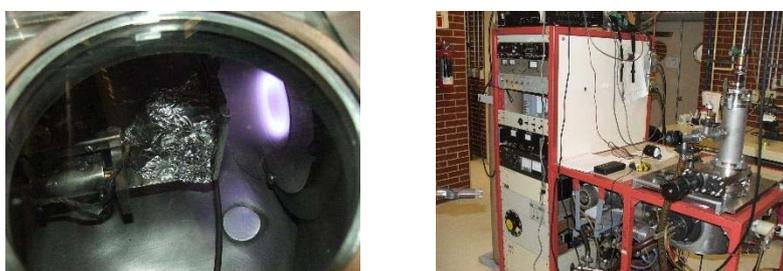
Figura 3.2 Sistema de sputtering utilizado.
