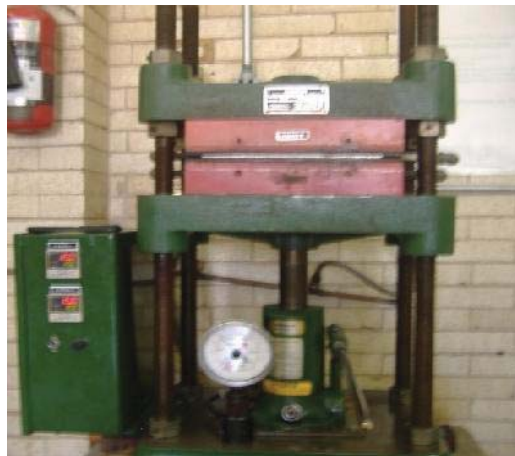
Figura 3.11. Prensa hidráulica usada para la elaboración de probetas.
