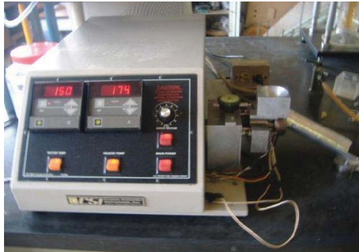
Figura 3.1. Equipo de extrusión marca Maxwell CS-194AV para realizar la funcionalización y producción de los materiales compuestos con arcilla.
