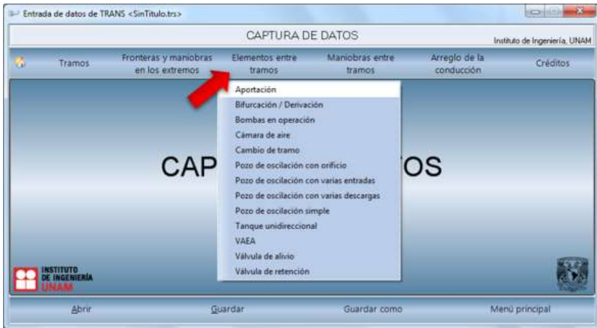
Fig. 6.15 Elementos entre tramos.
