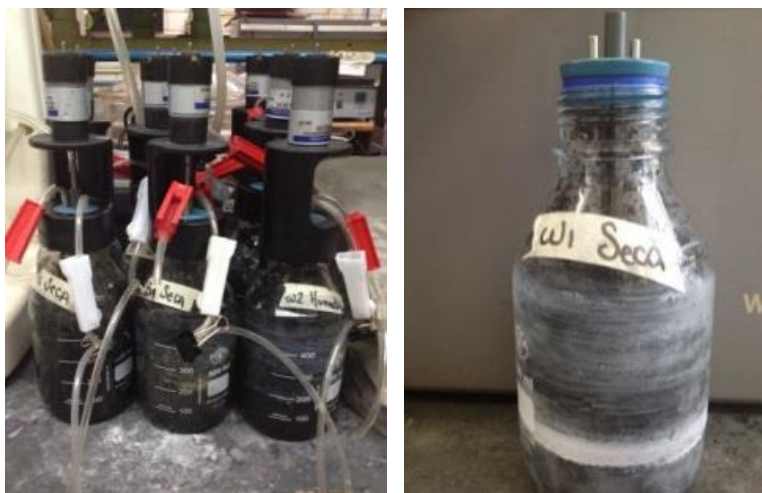
Figura 4.11 Reactor batch condiciones secas y húmedas.
