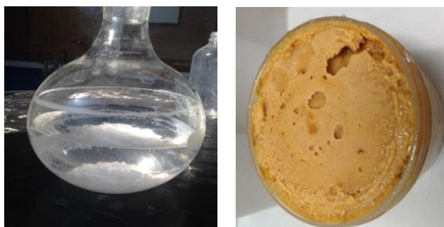
Figura 4.8 a) Mezcla de EtOH y KOH y b) grasa saponificada.
