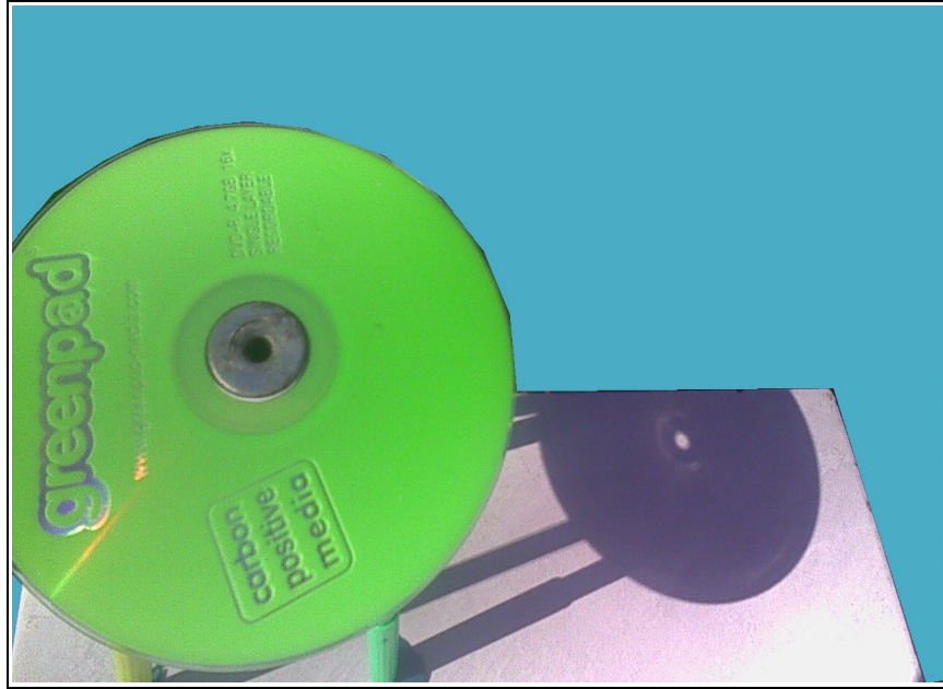
Figura 6.1.5 Foto de la imagen del Sol proyectada por el orificio de la rondana, al iniciar el experimento. El norte está a la derecha de la foto.
