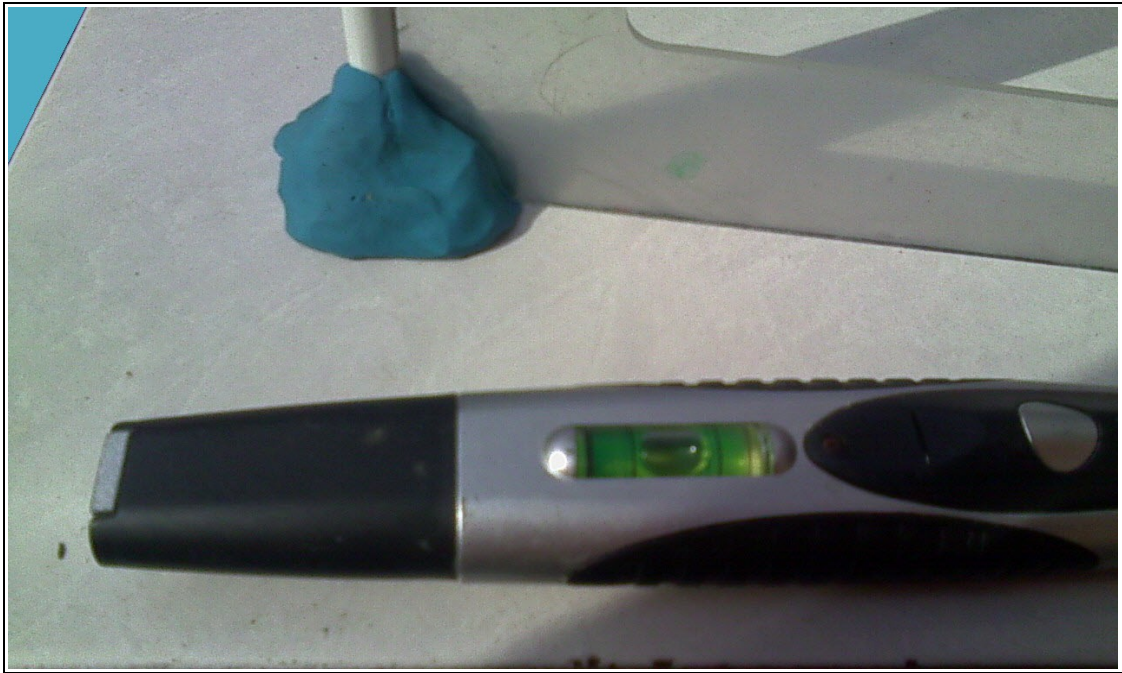
Figura 6.2.2 Foto de la superficie horizontal, ya nivelada.
