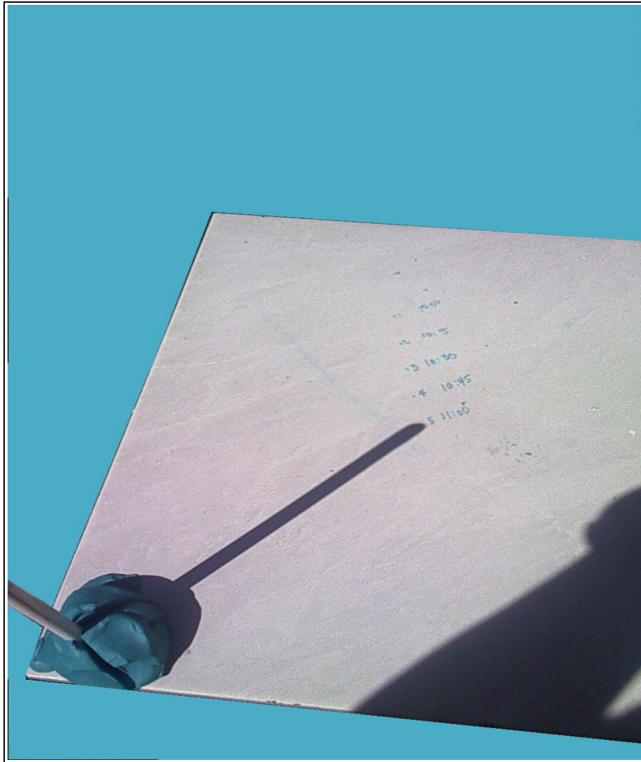
Figura 6.2.4 El Gnomon y las primeras lecturas, consistentes en marcar puntos al extremo de la sombra del estilete y las horas a las que ocurren cada una de ellas. Las medidas se tomaron durante 4 horas y cada 15 minutos, aproximadamente. La mediación de las distancias entre las marcas y el lugar donde se apoyó la base del estilete, se hicieron al termino del experimento..
