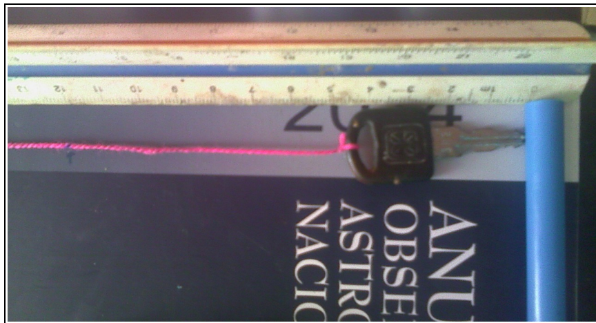
Figura 6.1.4 La distancia entre el extremo de la llave y el centro de la rondana (la altura del Banco Solar), de midió marcando previamente la posición de ésta en el estambre del que se suspendió la llave.
