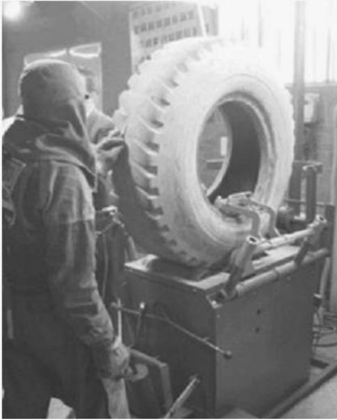
Ilustración 44 Inspección fase en la que se determina si la llanta esta apta para el renovado.
