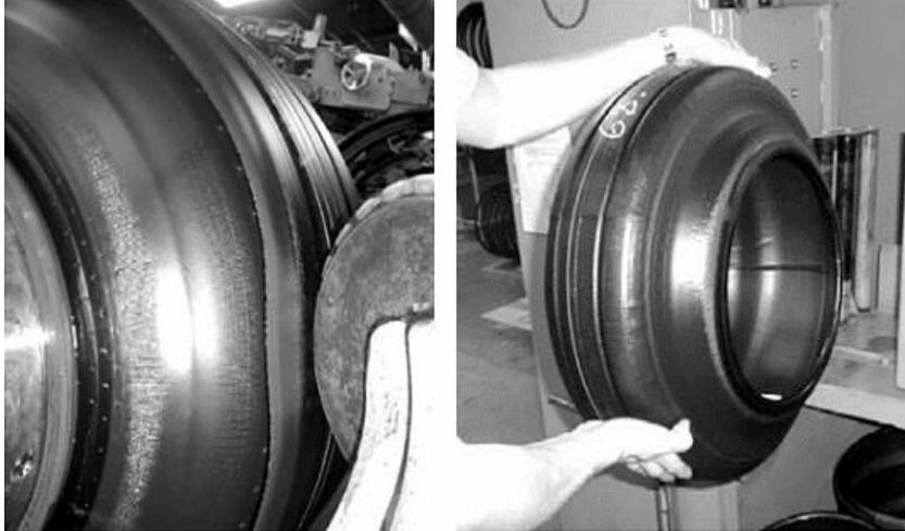
Ilustración 16 Por medio de presurización de aire, se abomban las capas de la carcasa hasta llegar al alma interna del cinturón. Carcasa y banda de rodamiento son unidas rápidamente, obteniendo un neumático en bruto (Green tyre), que después será transferido a la máquina. Fuente; <http://www.firestone.com>, 2010.
