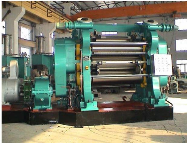
Ilustración 5 Máquina para expulsión de caucho o “Caldering” utilizada para el laminado de caucho. Fuente; [www.spanish.alibaba.com](http://www.spanish.alibaba.com) ,2011
