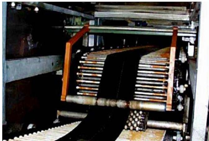
Ilustración 15 La mezcla sale del extrusor en forma de tira. Fuente; <http://www.firestone.com>, 2010.
