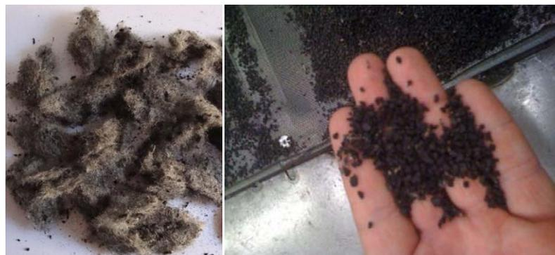
Ilustración 74 Grano libre de fibra textil e impurezas. Fuente: PS&TOOLS, Marzo/2012.
