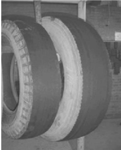
Ilustración 45 Raspado de la llanta evitando el daño a las cuerdas. Fuente: Empresa Grupo Guerrero González S.A, 2011
