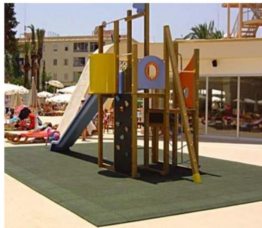
Ilustración 60 Superficie manufacturada a base de caucho reciclado. Fuente: [www.saviaproyectos.com](http://www.saviaproyectos.com), 2009.
