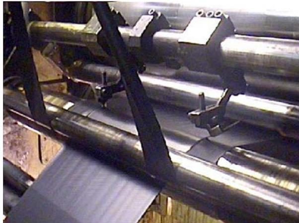
Ilustración 13 La mezcla de la calandria sale en forma de lámina o película. Fuente; <http://www.firestone.com>, 2010.
