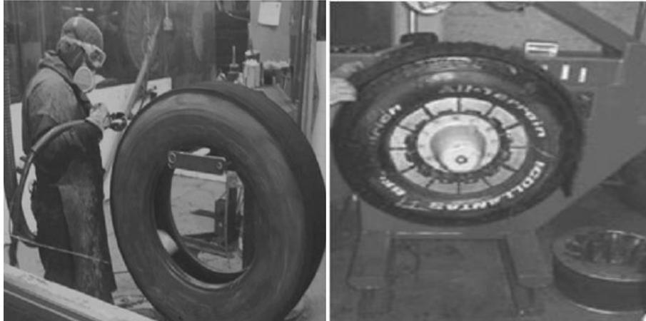
Ilustración 46 Aplicación de capas de caucho para la renovación. Fuente Empresa Grupo Guerrero González S.A, 2011.
