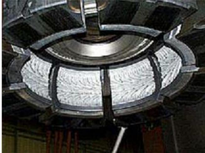
Ilustración 17 Tipo de molde separado en ocho partes, en el cual cada segmento trabaja a presión. Fuente; <http://www.firestone.com>, 2010.
