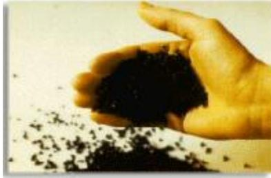
Ilustración 41 Hule molido por el proceso de Trituración o Molienda Mecánica. Fuente: [www.foroswebgratis.com](http://www.foroswebgratis.com), 2010.
