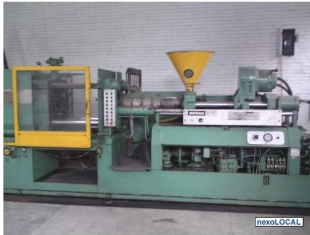
Ilustración 6 Prensas de expulsión o de inyección. Fuente; [www.interempresas.com](http://www.interempresas.com), 2010
