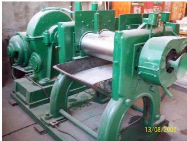
Ilustración 4 Máquina mezcladora de caucho. Fuente; [www.mclasificados.com.ar](http://www.mclasificados.com.ar), 2008
