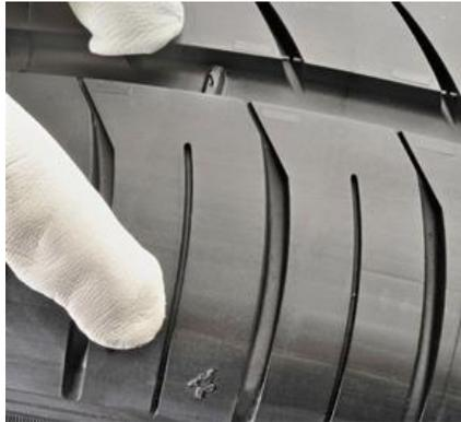
**Ilustración 12** Indicador de desgaste, cuando el indicador y el dibujo se encuentren al mismo nivel es hora de reemplazar la llanta. Fuente: [www.michelin.com](http://www.michelin.com), 2012.
