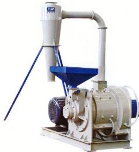
Ilustración 75 Máquina pulverizadora para la obtención de polvo de caucho, la cual utiliza sistema de discos para la pulverización. Fuente: [www.electronicaindustrial.com.uy](http://www.electronicaindustrial.com.uy), Agosto/2012
