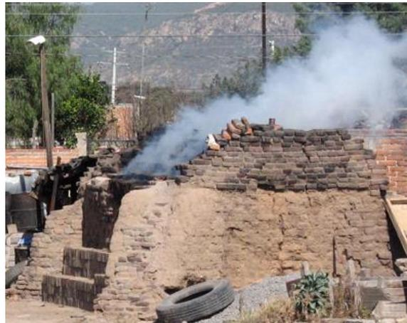
Ilustración 36 Horno para la producción de tabiques, el cual utiliza llantas desechadas como combustible. Fuente: [www.edomexico.gob.mx/se/ladrillo.html](http://www.edomexico.gob.mx/se/ladrillo.html), 2010
