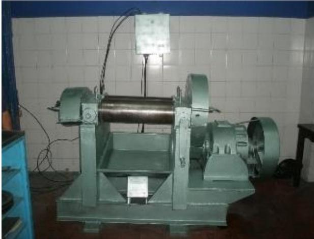
Ilustración 3 Máquina para el masticado de caucho, la cual suaviza el material para el paso siguiente. Fuente; [www.santander.evisos.com.co](http://www.santander.evisos.com.co), 2011
