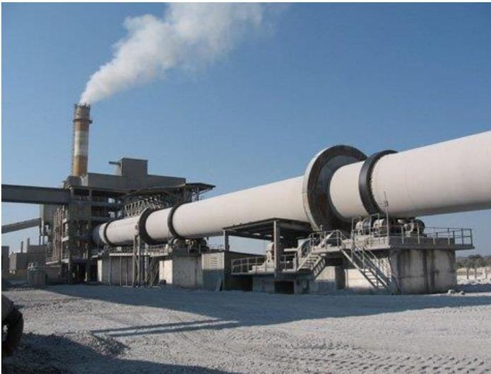
Ilustración 35 Horno rotatorio para la producción de cemento, el cual utiliza llanta triturada como combustible. Fuente [www.spanish.alibaba.com](http://www.spanish.alibaba.com) 2010.
