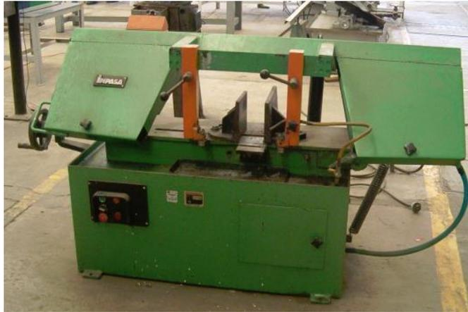
Figura 2.2 Sierra cinta empleada para corte de probetas.
