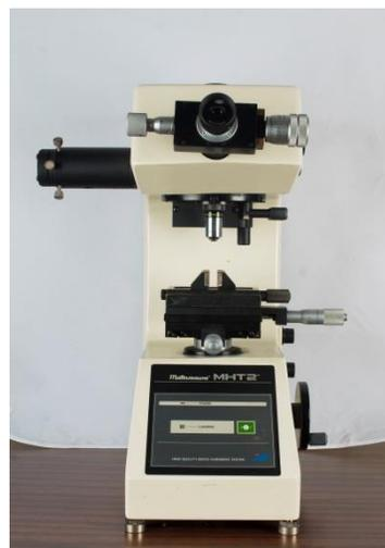
Figura 2.10 Microdurómetro empleado para los ensayos de microdureza.
