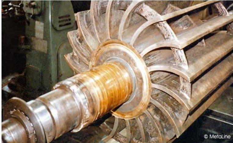
Fig. 1.9 Daños en el área del cojinete de una bomba de vacío. [13].
