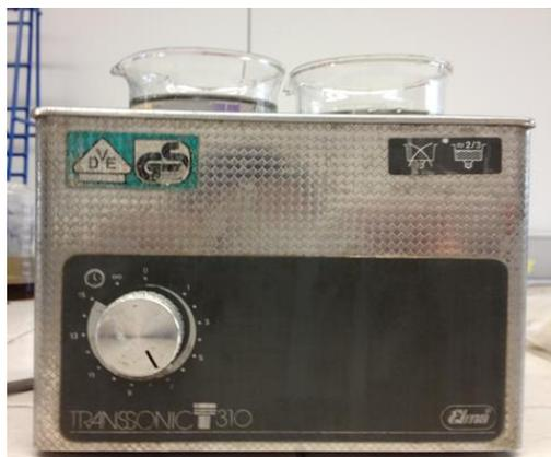
Figura 2.5. Equipo de limpieza ultrasónica.
