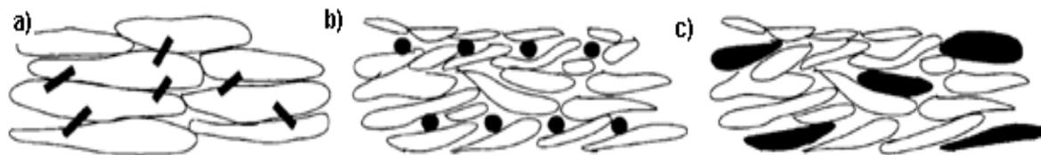
Fig. 1.22 Recubrimiento por proyección térmica reforzado con fibras (a), partículas (b), bigotes (c) [25].
