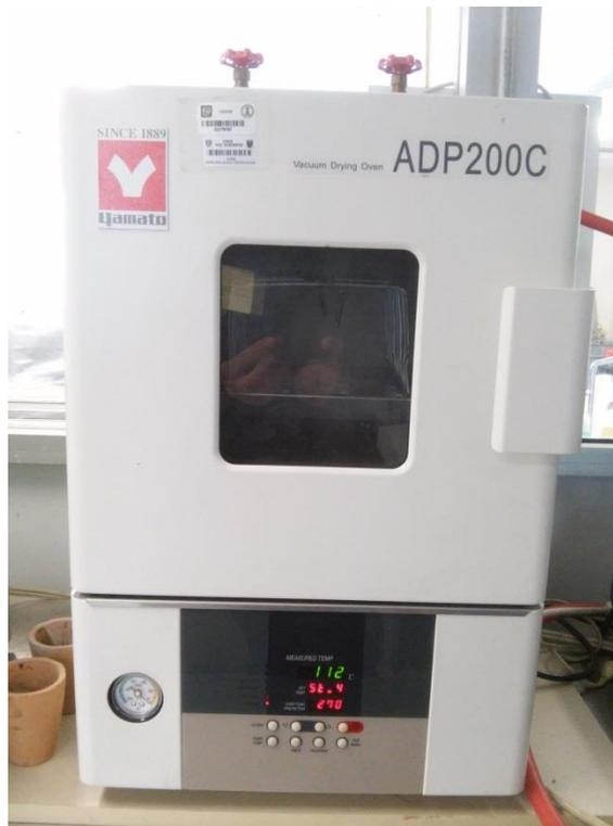
Fig. 2.27 Horno eléctrico para curado de Sol Gel utilizado.
