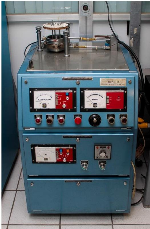
Figura 2.12. Equipo de desgaste y fricción.
