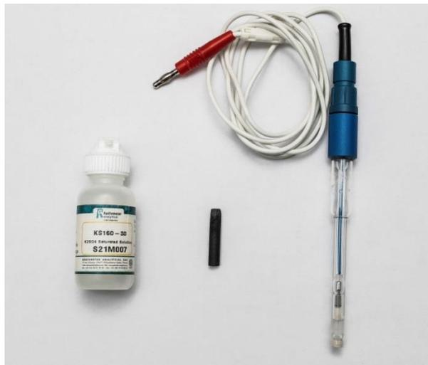
Figura 2.16. Solución de  $\text{K}_2\text{SO}_4$ , electrodo auxiliar de grafito y electrodo de referencia de  $\text{K}_2\text{SO}_4$  utilizados.
