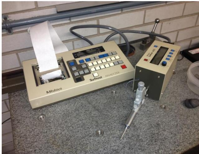
Figura 2.4. Rugosímetro digital Mitutoyo empleado para la evaluación de la rugosidad.
