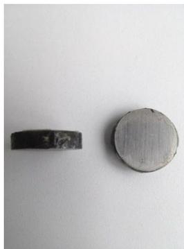
Fig. 2.24 Probetas de fundición nodular para recubrimiento Sol Gel.
