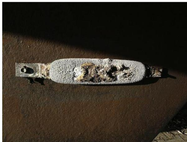
Fig. 1.8 Ánodo de sacrificio gastado de un ekranoplano [11].
