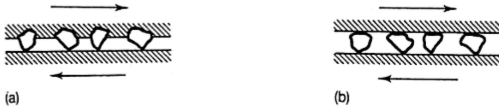
Fig. 1.12 Desgaste abrasivo de a) dos cuerpos, b) tres cuerpos [18].
