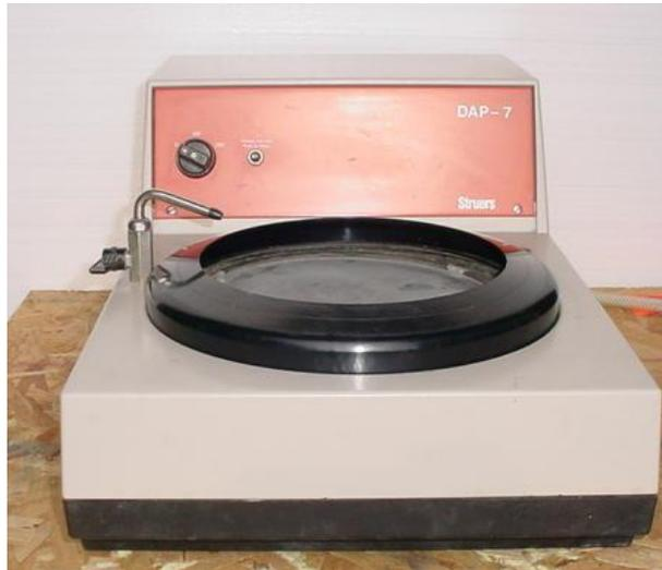
Figura 2.9 Equipo de pulido y lijado empleado.
