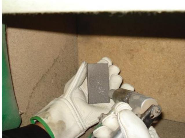
Figura 2.3 Proceso de granallado.
