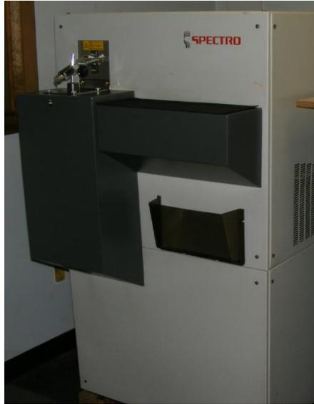
Fig. 2.19 Espectrómetro de Emisión Óptica empleado.
