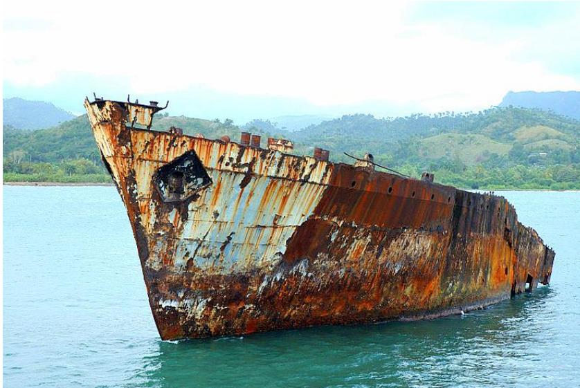
Fig 1.1 Deterioro del metal por corrosión [2].
