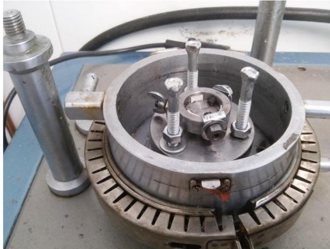
Fig. 2.26 Dispositivo para aplicación de Sol Gel por spin coating empleado.
