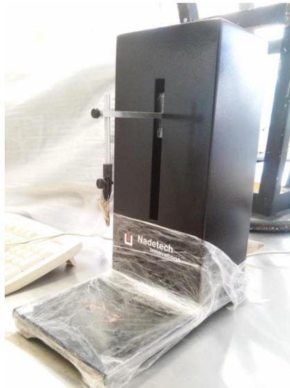
Fig. 2.25 Equipo que se usó para aplicación de aminosilano por dip coating.
