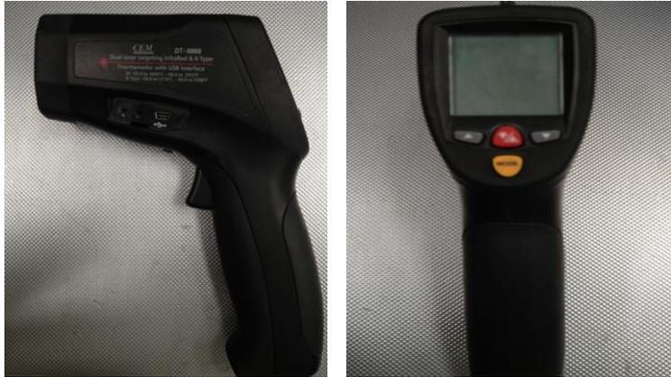
Figura 2.6 Pirómetro digital utilizado.
