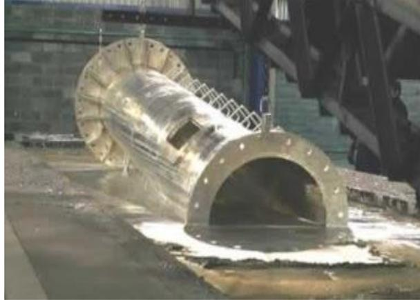
Fig. 1.7 Galvanizado de tuberías por inmersión en caliente [10].
