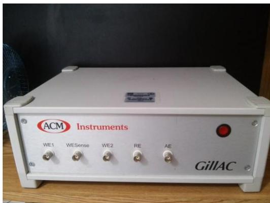
Fig. 2.17. Potenciostato empleado en la prueba de EIS.
