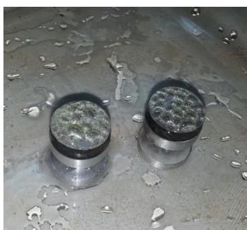
Figura 3.29. Probetas de fundición nodular atacadas con HCl que evidencia el área desprendida en la prueba de pull off.
