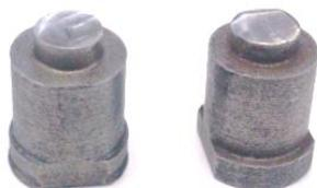
Figura 2.21. Probetas maquinadas en fundición nodular para ensayos de desgaste.
