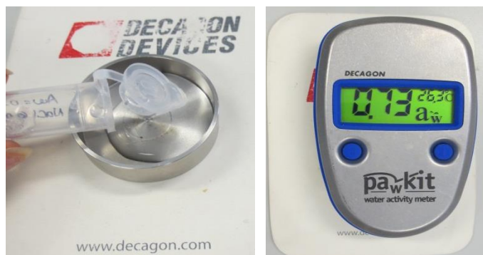
Figura 24 Calibración del higrometro de punto de rocío Pa w kit
