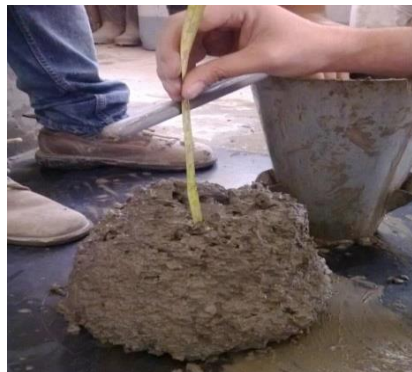
Imagen 4.1. Ensaye de revenimiento
