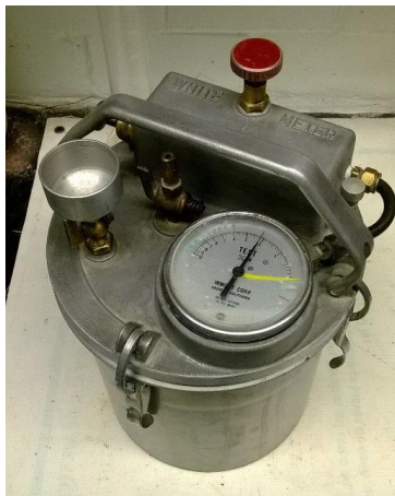
Imagen 4.2. Fotografía del aparato para medir el contenido de aire.
