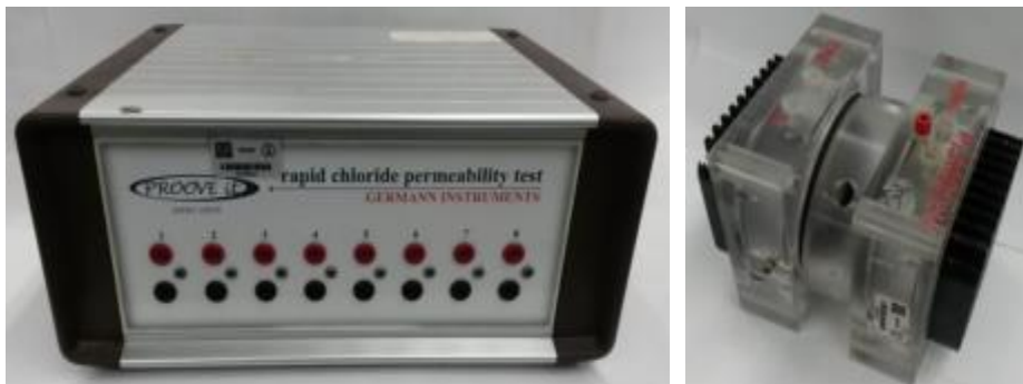
Imagen 2.8. Fotografía de la unidad PROOVE'it y ejemplo de la celda, con la cual se capta la permeabilidad.
