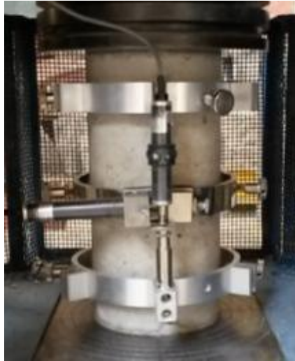
Figura D. Ensayo para las pruebas de módulo de elasticidad y relación de Poisson.
