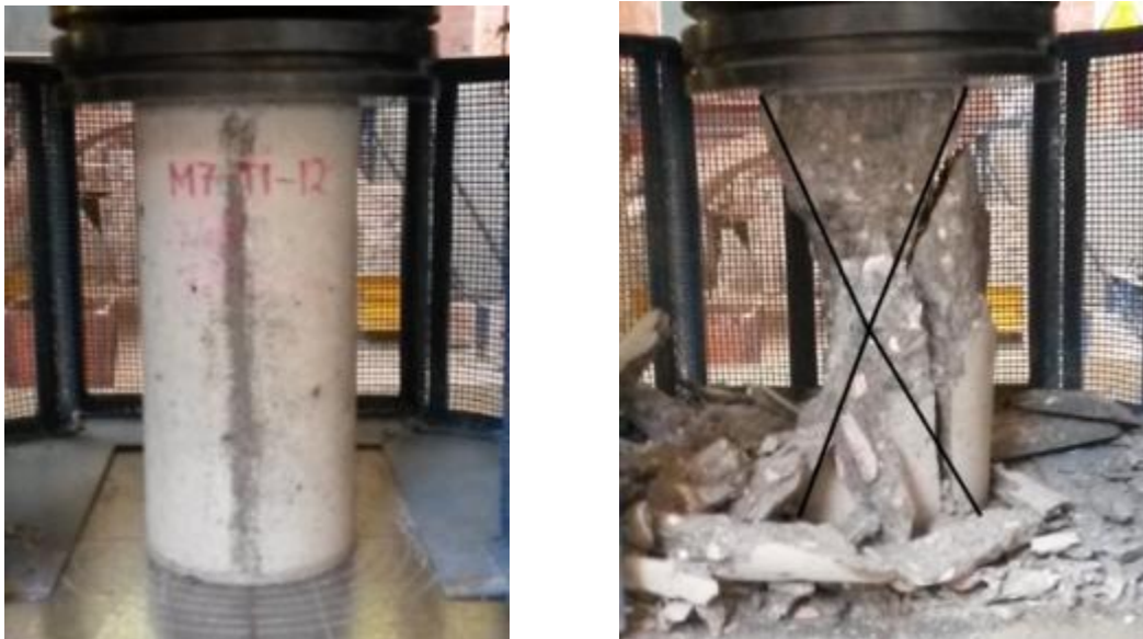
Figura A. Ensayo a compresión de la mezcla 4 a 91 días.
