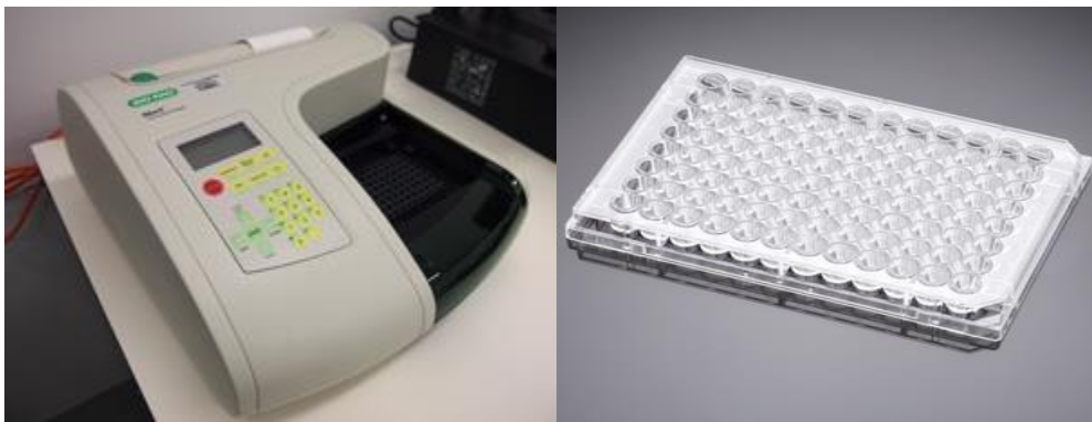
Figura 14. Lector de placas iMarck y microplaca de 96 pozos utilizados en el estudio.
