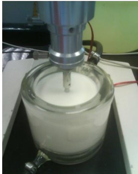
Figura 37. Representación del arreglo para el experimento de cizalla estacionaria.
