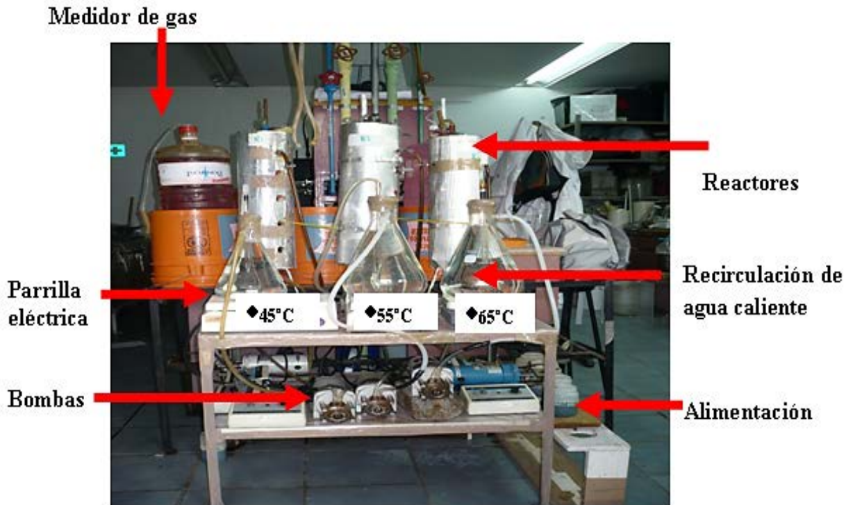
Figura 3.1. Reactores anaerobios de lecho de lodos de flujo ascendente (RALLFA) a 45, 55 y 65°C
