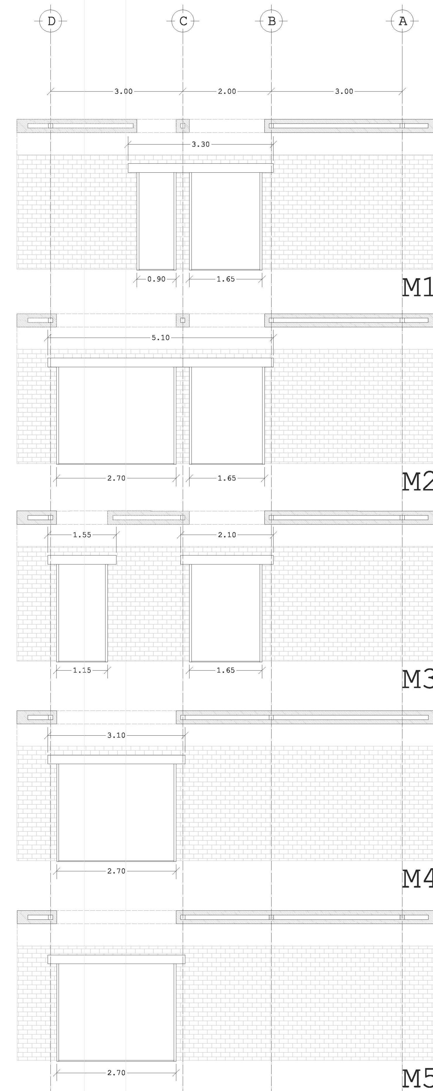
CLAROS EN MUROS DE TRR
