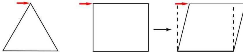
*Fig 1.2 La geometría más estable es el triángulo*
