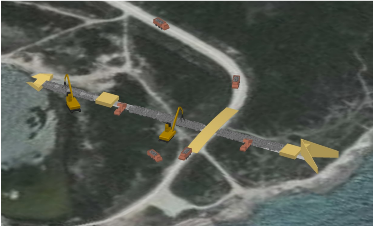
Figura 6: Esquema del REALCO con amplificador en la costa y canal de comunicación con la laguna. Fuente: Dr. Martín Merino Ibarra.
