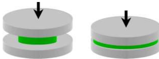
Figura 1. Flujo por compresión axi-simétrico, con una masa constante de la muestra entre los platos. (Engmann et al. 2005).
