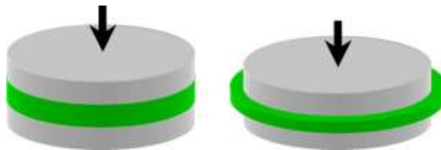
Figura 2. Flujo por compresión axi-simétrico, con área de contacto constante entre los platos y la muestra. (Engmann et al. 2005).
