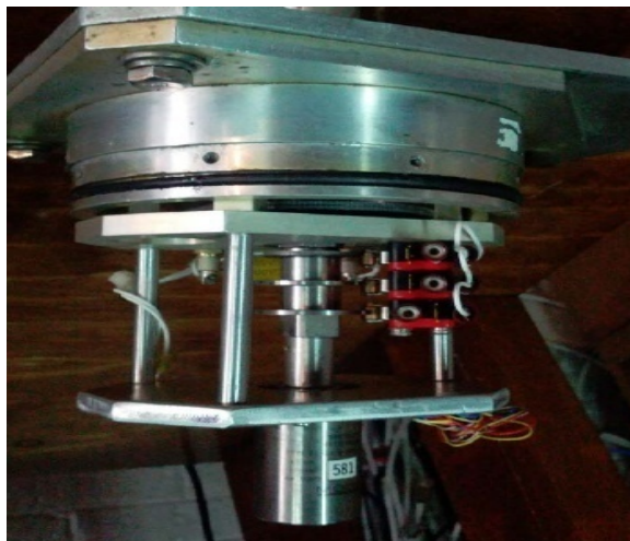
Fig. 4-3 Montaje del resolver y del limitador en un protector de aluminio
