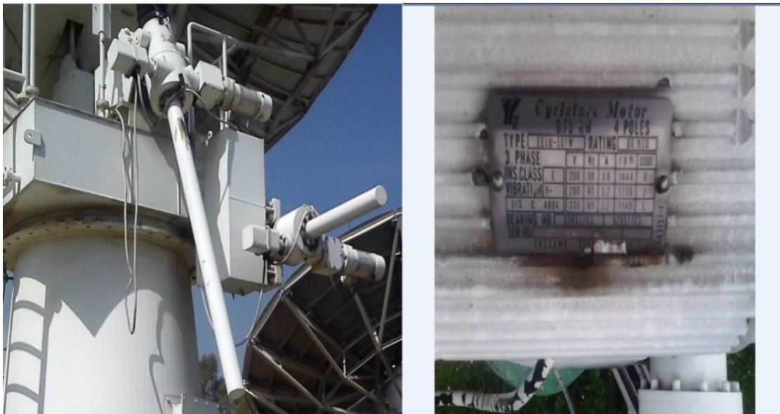
Fig. 3-3 Motores para movimiento de la antena y placa de datos del motor
