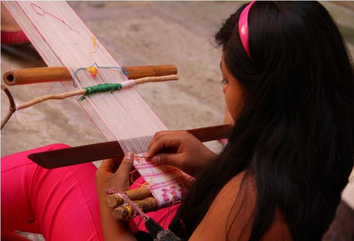
El telar consiste en dos tiras horizontales y paralelas sujetas por correas –enjulios– en los extremos de la urdimbre. El enjullo superior se fija a un elemento vertical, estaca clavada al piso, poste o árbol.
