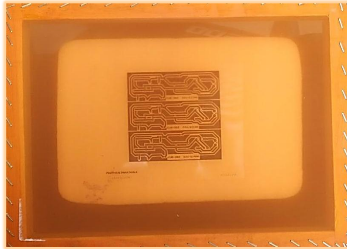
Figura 5.2 Grabado del diagrama sobre la malla de serigrafía
