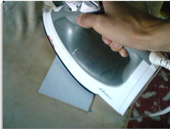
Figura 5.14 Planchado de la placa fenólica con el diagrama PCB
