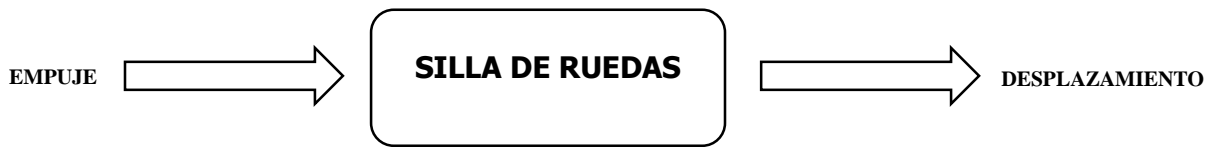
Fig. 3.2 Diagrama de caja negra de la silla de ruedas
