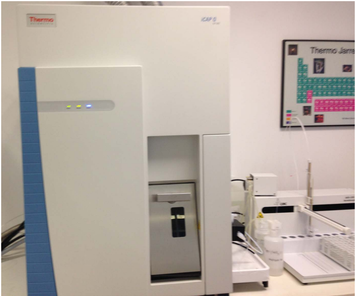
Fig. 9. ICP-M iCAP® TM marca THERMO SCIENTIFIC ubicado en el Instituto de Geofísica de la UNAM, Ciudad Universitaria.
