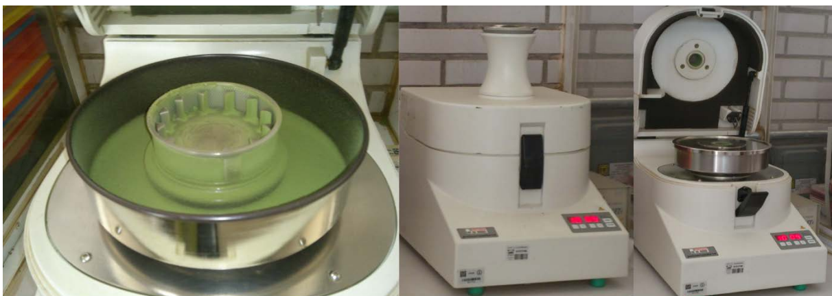
Fig. 4 . Pulverizador Pulverisette 14 del taller de molienda del Instituto de Geología, UNAM.
