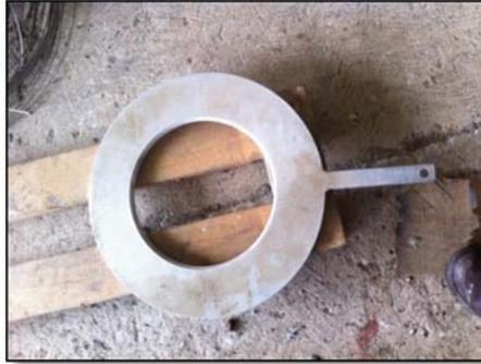
Figura 2.12 Placa orificio para medir flujo de vapor.
