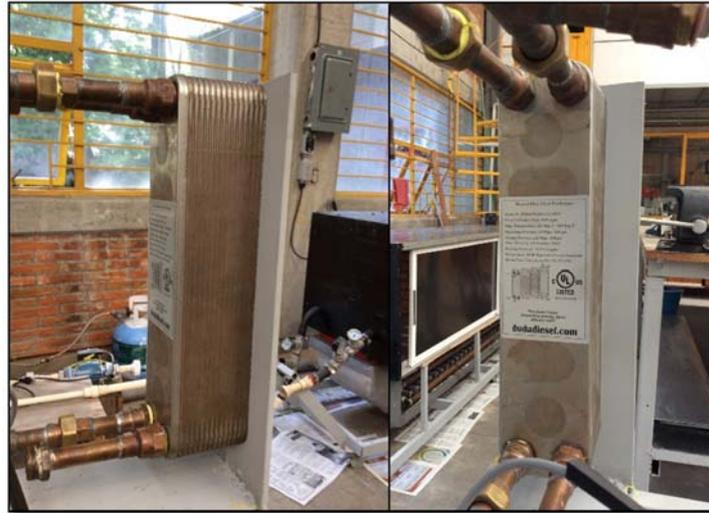
Figura 3.30 Intercambiador de calor de placas marca DudaDiesel.
