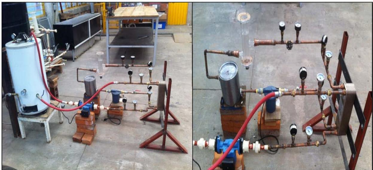
Figura 3.22 Primera etapa del sistema experimental de generación de vapor.
