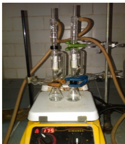
Figura 18 Montaje de equipo de extracción.
