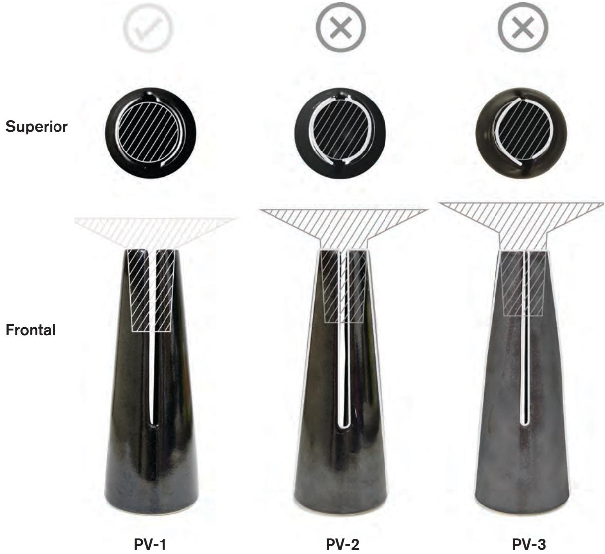
El esquema P-02 presenta una comparativa sobre las deformaciones en los primeros prototipos.
