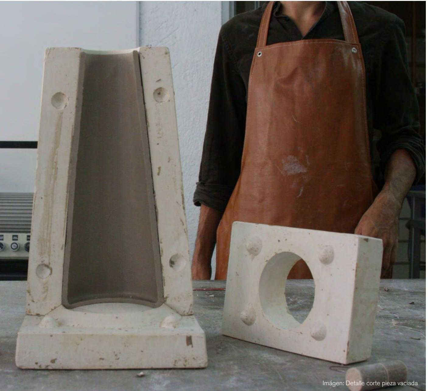
Imágen: Detalle corte pieza vaciada
