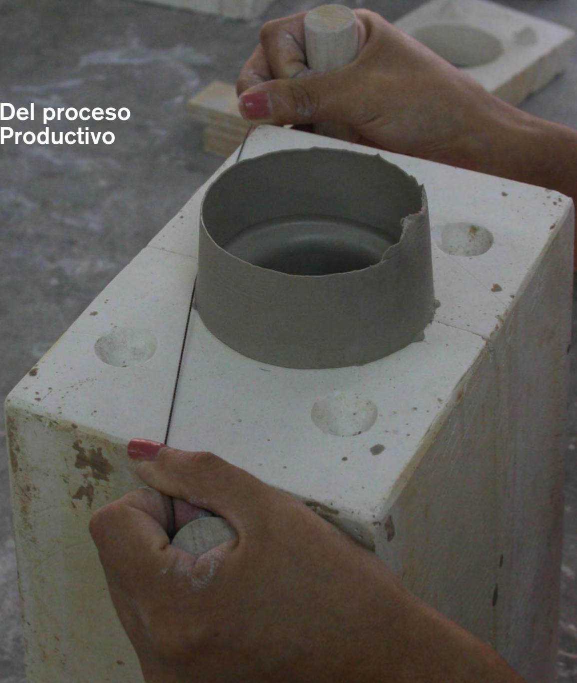
Todos los elementos están fabricados en stoneware por el proceso de vaciado en un molde de yeso.
