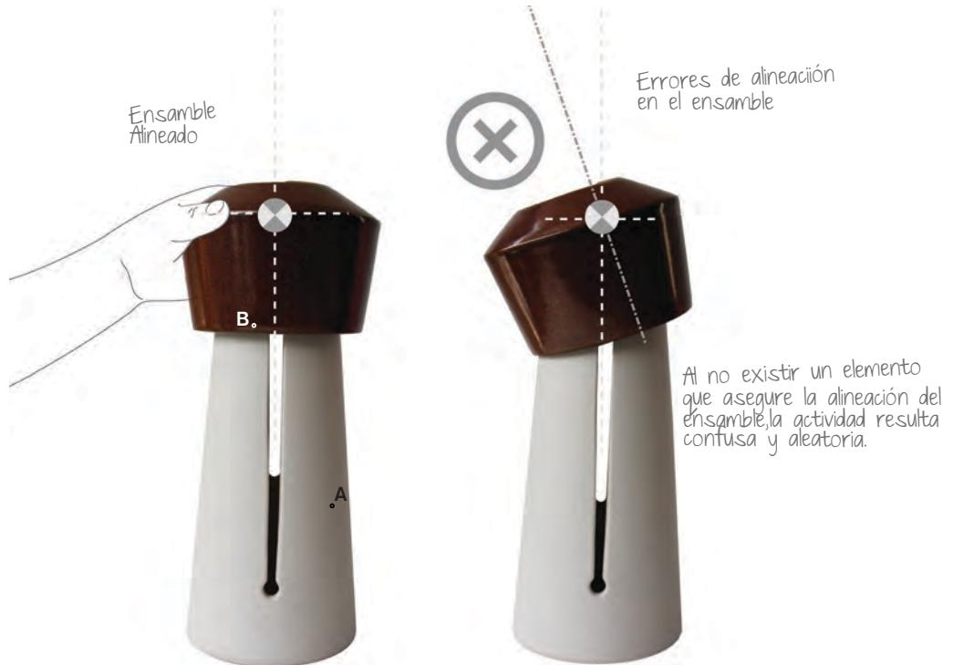
Para asegurar que las piezas quedarían ensambladas correctamente al conformar el *Objeto Decorativo*, se desarrolló una nueva propuesta de sujeción entre las piezas A y B (PR-4).
