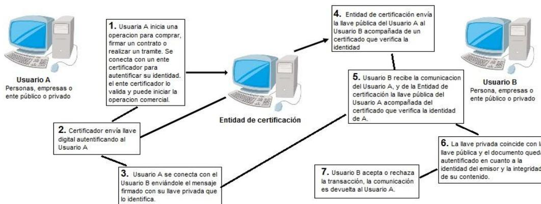
**Ilustración 8. Autenticación de firma electrónica.**
