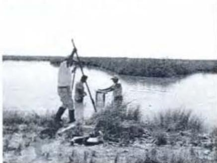
Instalación de un piezómetro en el ANP Cuatrociénegas, Coahuila.
