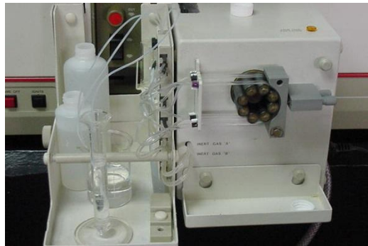
Figuras 5.5. a) y b) Fotografías del Espectrofotómetro de Absorción Atómica (SpectrAA800) y el generador de hidruros (VGA77) empleados.
