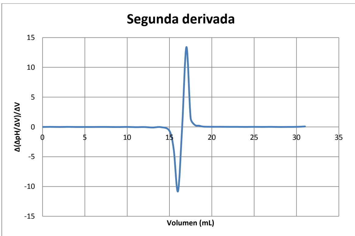
Gráfico 6.3. Segunda derivada y volumen de punto de equivalencia de la valoración potenciométrica del filtrado después de la saturación.
