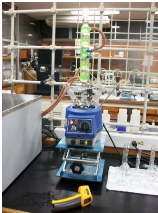
Figura 2-2. Arreglo experimental para la síntesis de CdSe.
