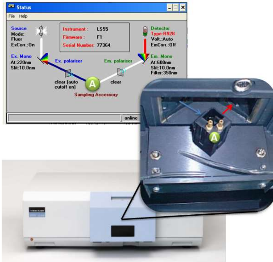
Figura 2-6. Accesorio del equipo de fotoluminiscencia para la medición de muestras líquidas.
