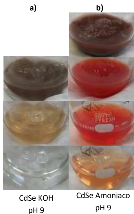
Figura 4-1. Transiciones de color en la síntesis de CdSe con KOH o con amoníaco.
