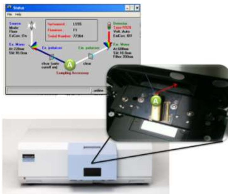
Figura 2-5. Arreglo óptico para la medición de fotoluminiscencia de muestras sólidas.
