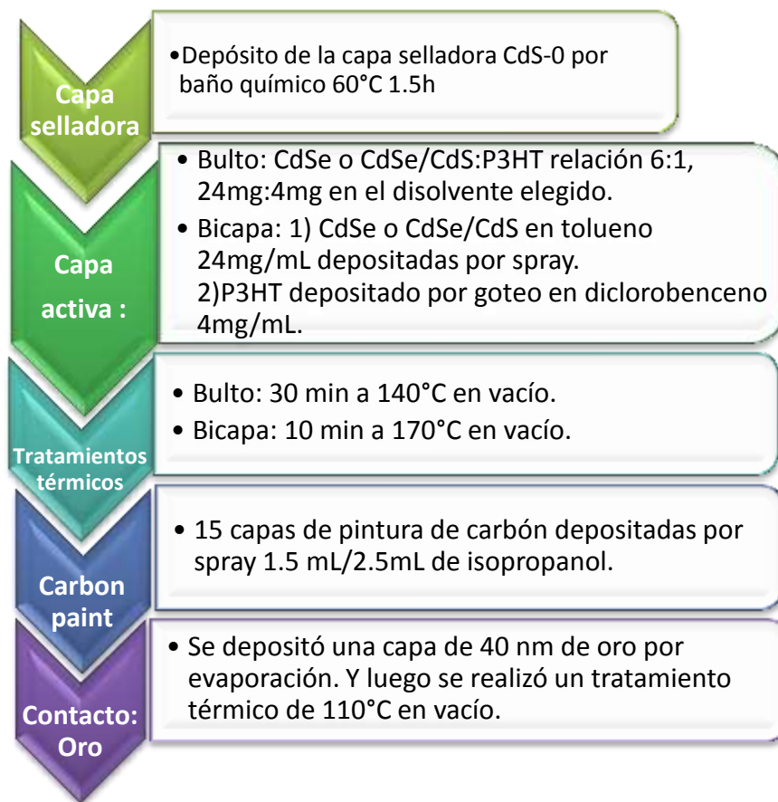
Figura 2-7. Proceso de la preparación de celdas solares híbridas.
