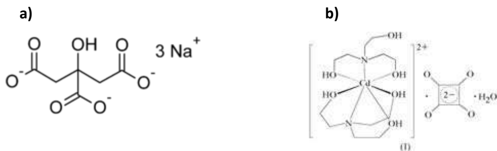
Figura 4-14. (a) Citrato de sodio y (b) trietanolamina (TEA) formando el complejo con cadmio. El cadmio se acompleja con cuatro moléculas de citrato de sodio y con dos moléculas de TEA.
