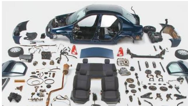
Figura 4.6 Piezas de un automóvil desensamblado
