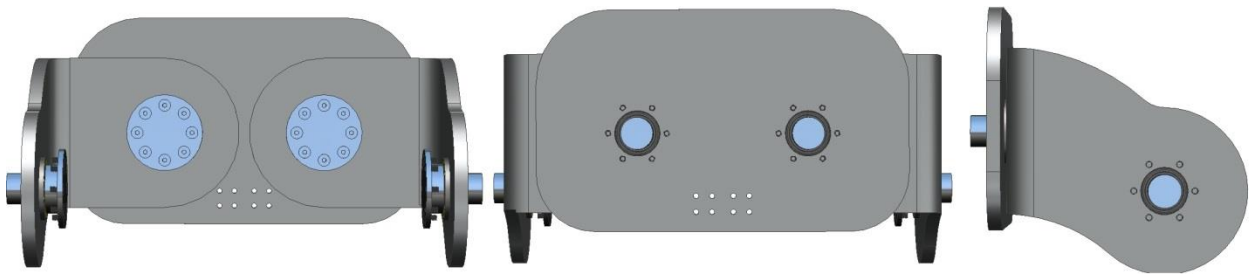
Figura 48. Vistas frontal, trasera y lateral de la articulación de cadera.
