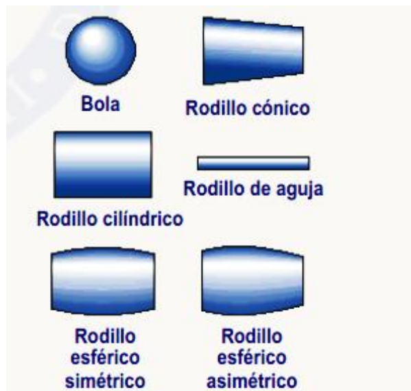
Figura 45. Tipo de elementos rodantes de un rodamiento [39].
