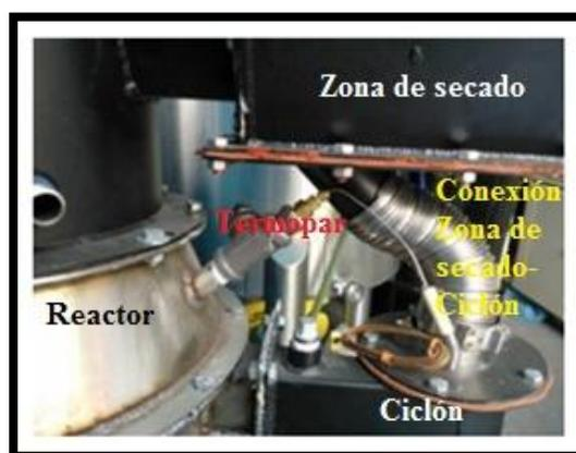
**Figura 4.18** Fotografía de conexión de línea de gas
