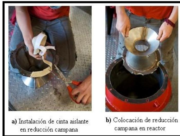
**Figura 4.6** Fotografías de instalación de reducción de campana
