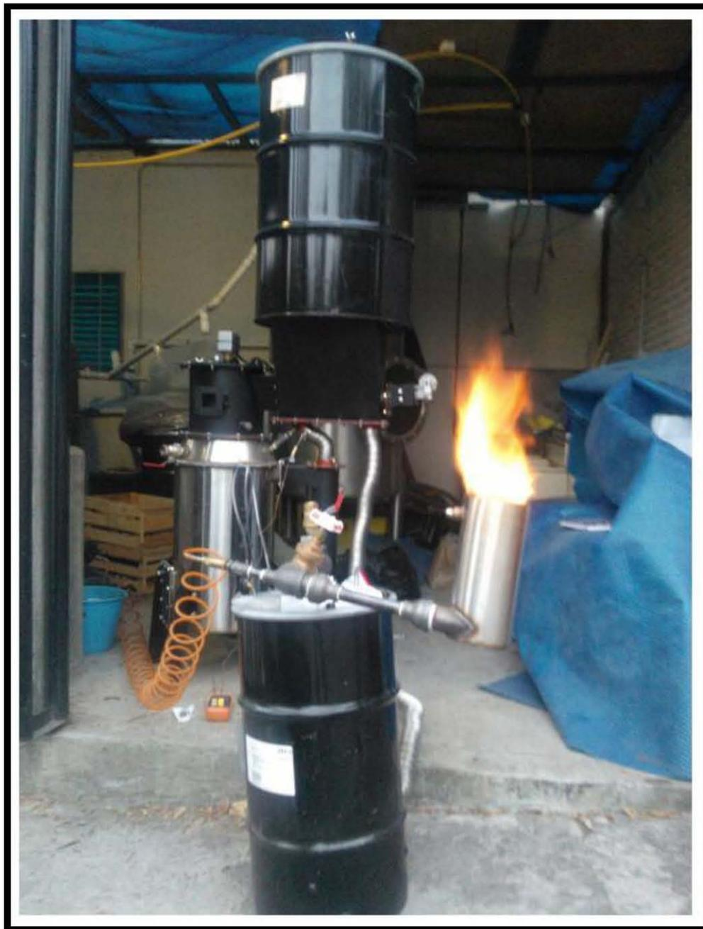
**Figura 4.23** Fotografía del gasificador operando
