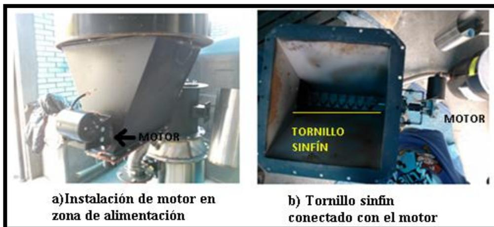
**Figura 4.15** Fotografías del motor y tornillo sinfín en zona de alimentación de combustible
