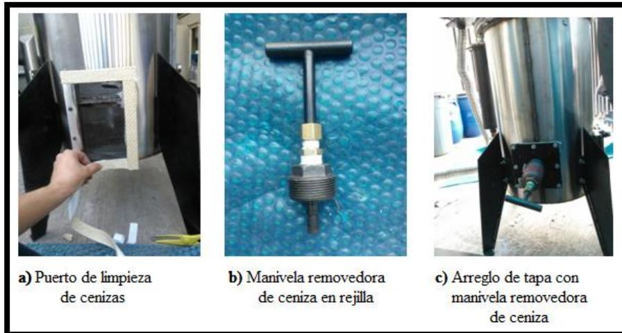
**Figura 4.10** Fotografías de colocación de manivelas de limpieza
