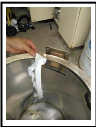
**Figura 4.2** Fotografía de la adherencia de junta aislante en reactor
