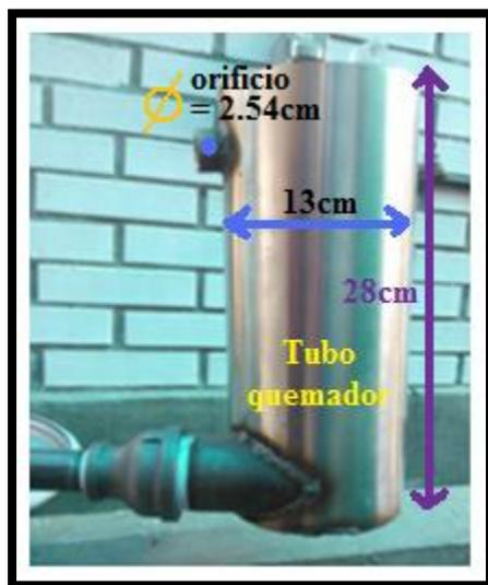
Figura 3.18 Fotografía del tubo quemador de acero inoxidable
