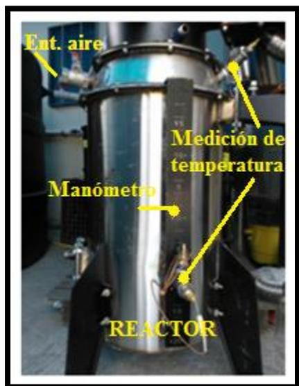
Figura 3.9 Fotografía del reactor de gasificación
