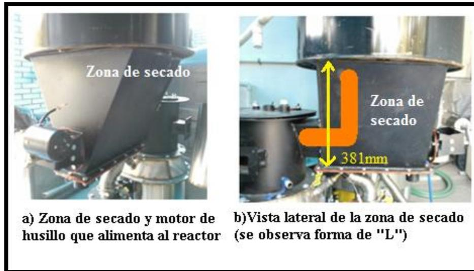
**Figura 3.6** Fotografías de la zona de secado
