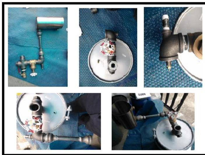
Figura 4.13 Arreglo del eyector Venturi
