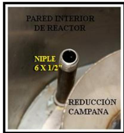
**Figura 4.5** Fotografía de boquillas de entrada de aire
