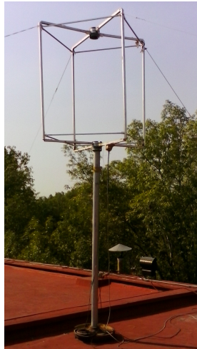
Figura 3.4: La figura muestra el arreglo compuesto por 2 antenas de tipo lazo situado en la azotea del IGEF.
