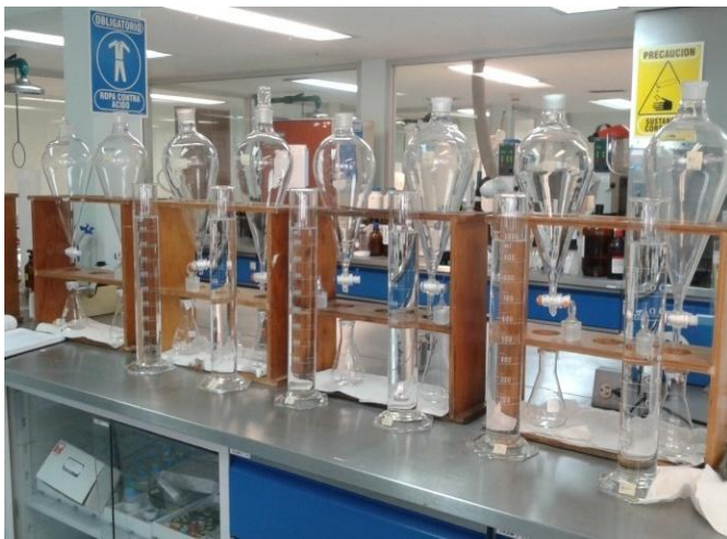
Figura 5. Material de cristalería para la extracción líquido-líquido.
