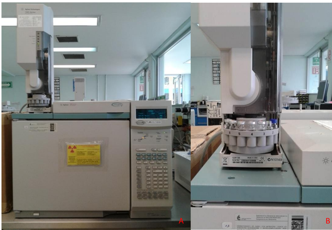
Figura 13.A. Cromatógrafo de gases con micro detector de captura de electrones. B. Instrumentación de las muestras sintéticas en el CG.
