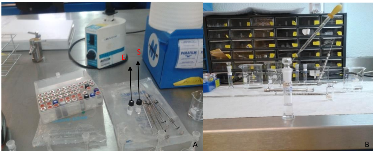
Figura 12. A. Elaboración de la Curva de Calibración, Estándar (E) y surrogado (S) .B. Aforo del punto de la Curva de calibración.
