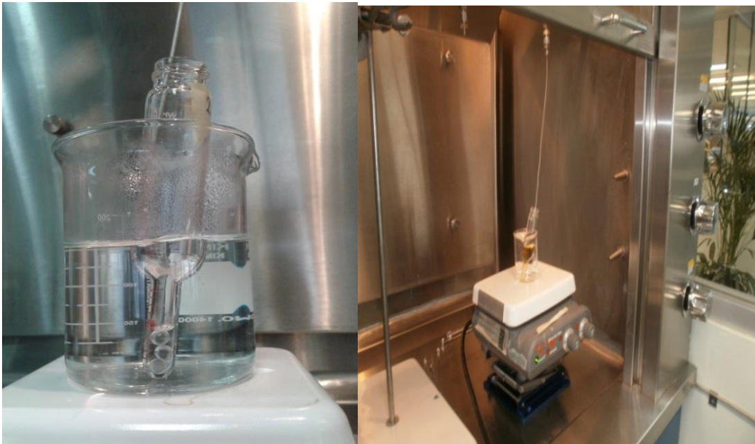
Figura 10. Micro-concentración mediante purga de Nitrógeno.
