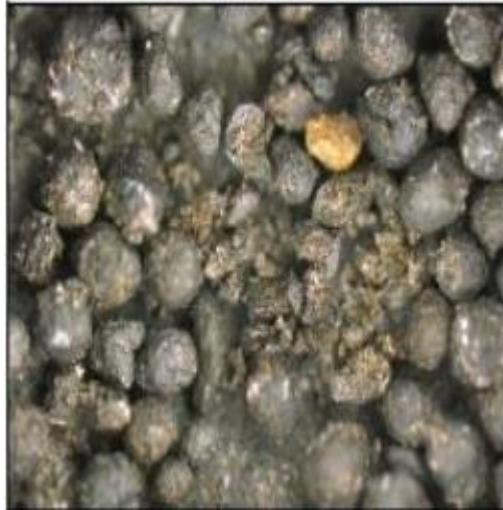
Figura 1.47 Presencia de “ crushing ” generado durante el ensayo de empotramiento (Tomada de Schlumberger, 2003)
