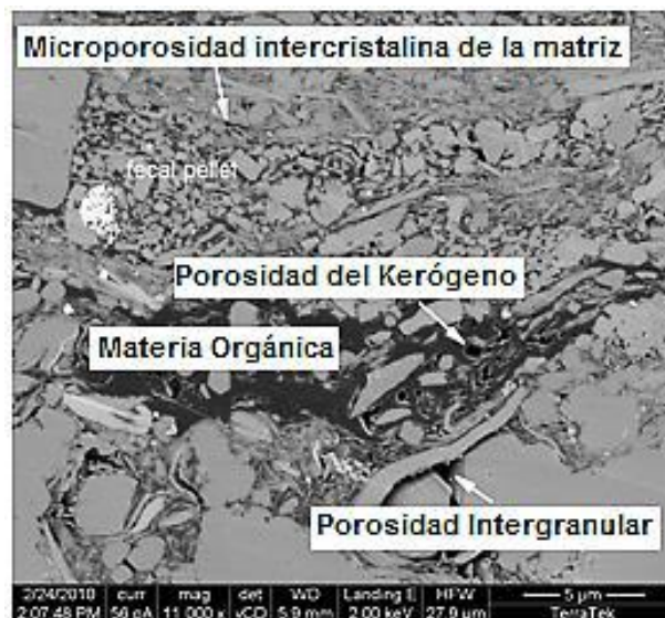
Figura 1.31 Tipos de porosidad presentes en shale gas (Modificada de Quirein et al, 2011)
