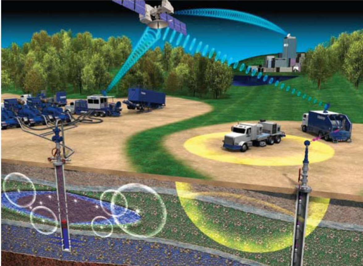
Figura 1.51 Monitoreo microsísmico en tiempo real (Tomada de Schlumberger 2012)
