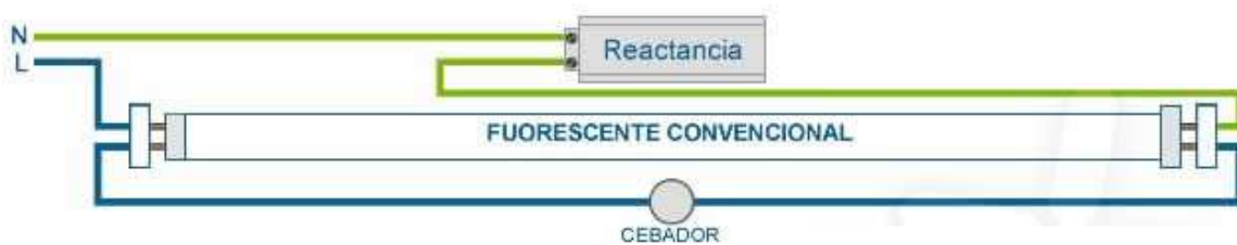
Figura 42 Conexión de tubos fluorescentes [7]
