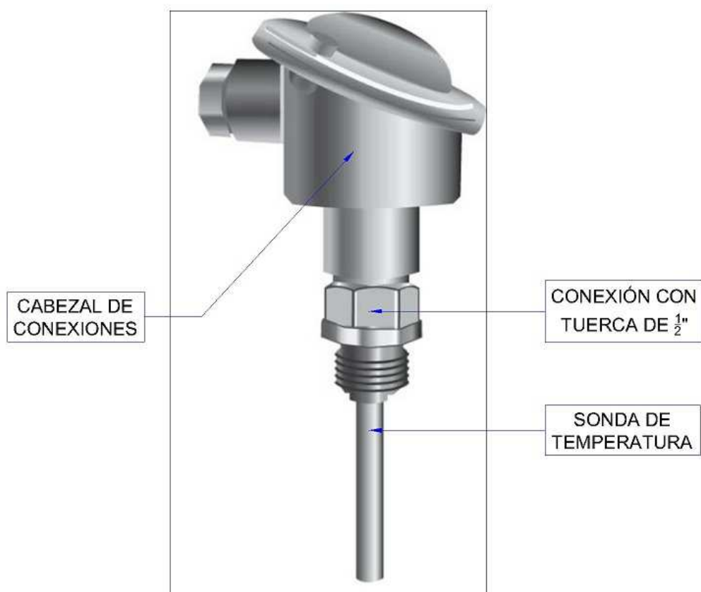
Figura 3.7 Transmisor de temperatura.
