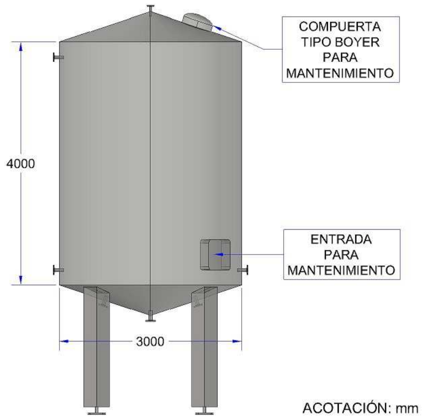
Figura 2.1 Diámetro y altura de los tanques principales.
