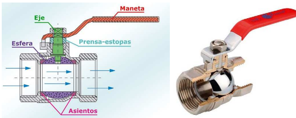
Figura 3.12 Esquema (izquierda) y corte (derecha) de una válvula manual tipo bola abierta.
