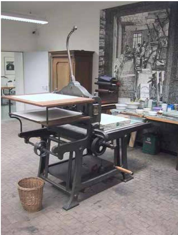
Figura 9. Sobre de estas líneas tenemos una prensa para litografía (izq.) Prensa para litografía, imagen tomada de wikipedia: <http://es.wikipedia.org/wiki/Litograf%C3%ADa> consultada el 15 de octubre de 2011.
