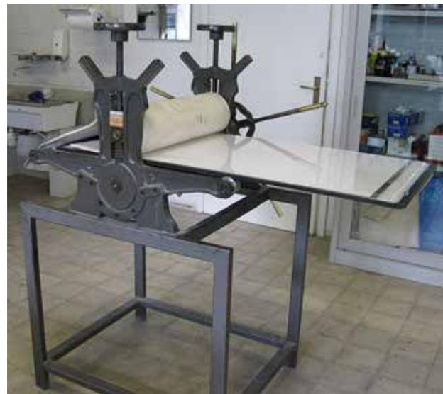
Figura 10. Una prensa para calcografía o grabado (der). Prensa para grabado: Imagen tomada de wikipedia: <http://es.wikipedia.org/wiki/T%C3%B3rculo> consultada el 15 de octubre de 2011.
